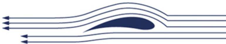
Betrachtet man einen Flugzeugflügel im Profil, so sieht man, dass er oben stark gewölbt und unten fast flach ist. Bewegt sich der Flügel durch die Luft, strömt die Luft oben deutlich schneller um den Flügel als auf der Unterseite. Dadurch entsteht oben ein geringerer Druck als unten – Auftrieb resultiert, das Flugzeug steigt nach oben.
