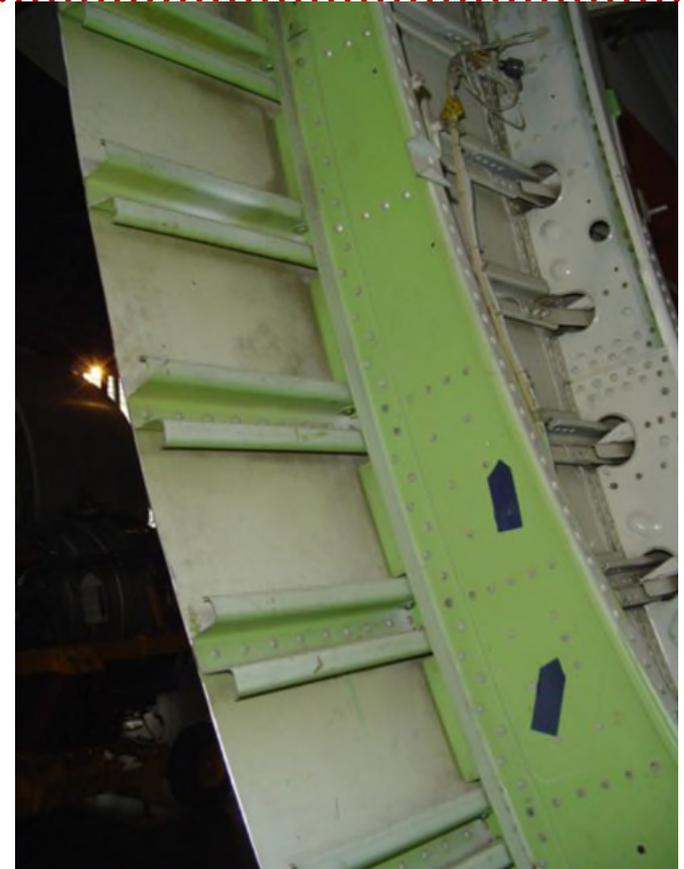
Rumpf einer Boeing 747 mit Aluminium-Außenhaut, gebogenen Spanten und in Längsrichtung verlaufenden Stringern für eine zusätzliche Verstärkung
