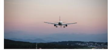
Zum Tragwerk des Flugzeuges gehören alle Bestandteile, die für den Auftrieb des Flugzeuges sorgen. Das sind vor allem die Flügel. Die Landeklappen werden bei der Landung ausgefahren, um das Flugzeug abzubremsen. Ohne die Landeklappen müsste das Flugzeug mit fast 400 Stundenkilometern aufsetzen. Das wäre viel zu schnell. Dank den Klappen kann sich das Flugzeug auf etwa 270 Stundenkilometer abbremesen.
