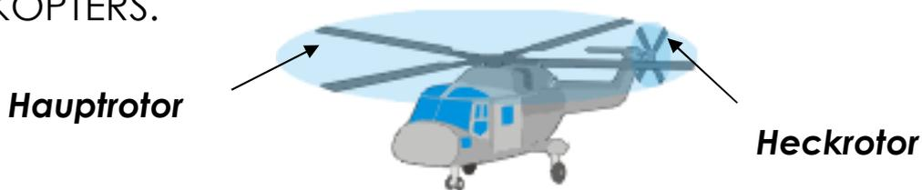
MIT DEN ROTOREN (DREHFLÜGELN) WIRD DIE LUFT NACH UNTEN GEBLASEN. DADURCH GEWINNT DER HELIKOPTER AN AUFTRIEB (ER STEIGT IN DIE LUFT).
