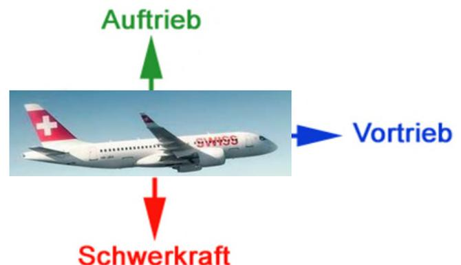
ES BRAUCHT ALSO NOCH EINE KRAFT, DIE GENAUSO STARK WIE DIE SCHWERKRAFT IST UND DAS FLUGZEUG NACH OBEN ZIEHT. DIES IST DER AUFTRIEB.
