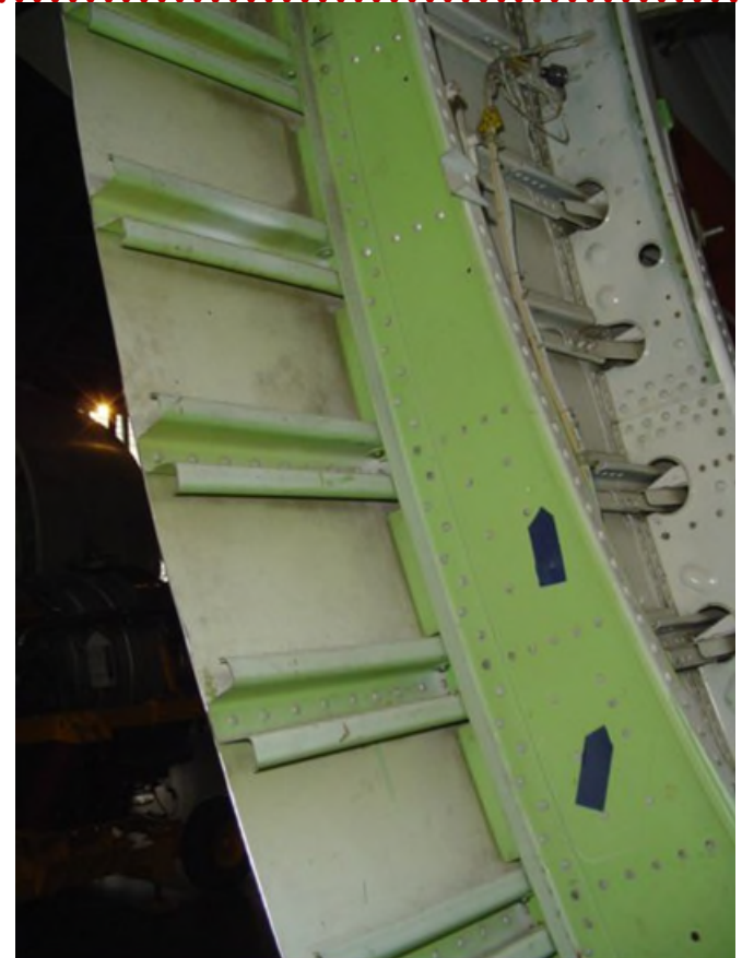
Rumpf einer Boeing 747 mit Aluminium-Aussenhaut, gebogenen Spanten und in Längsrichtung verlaufenden Stringern für eine zusätzliche Verstärkung
